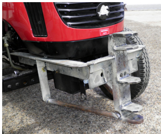
Construcción de enganches en la parte frontal
